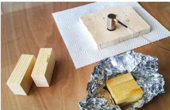
Versuch im Labor mit Larven von Splintholzkäfern und Hausbock mittels IADS (Insect Activity Detection System).
